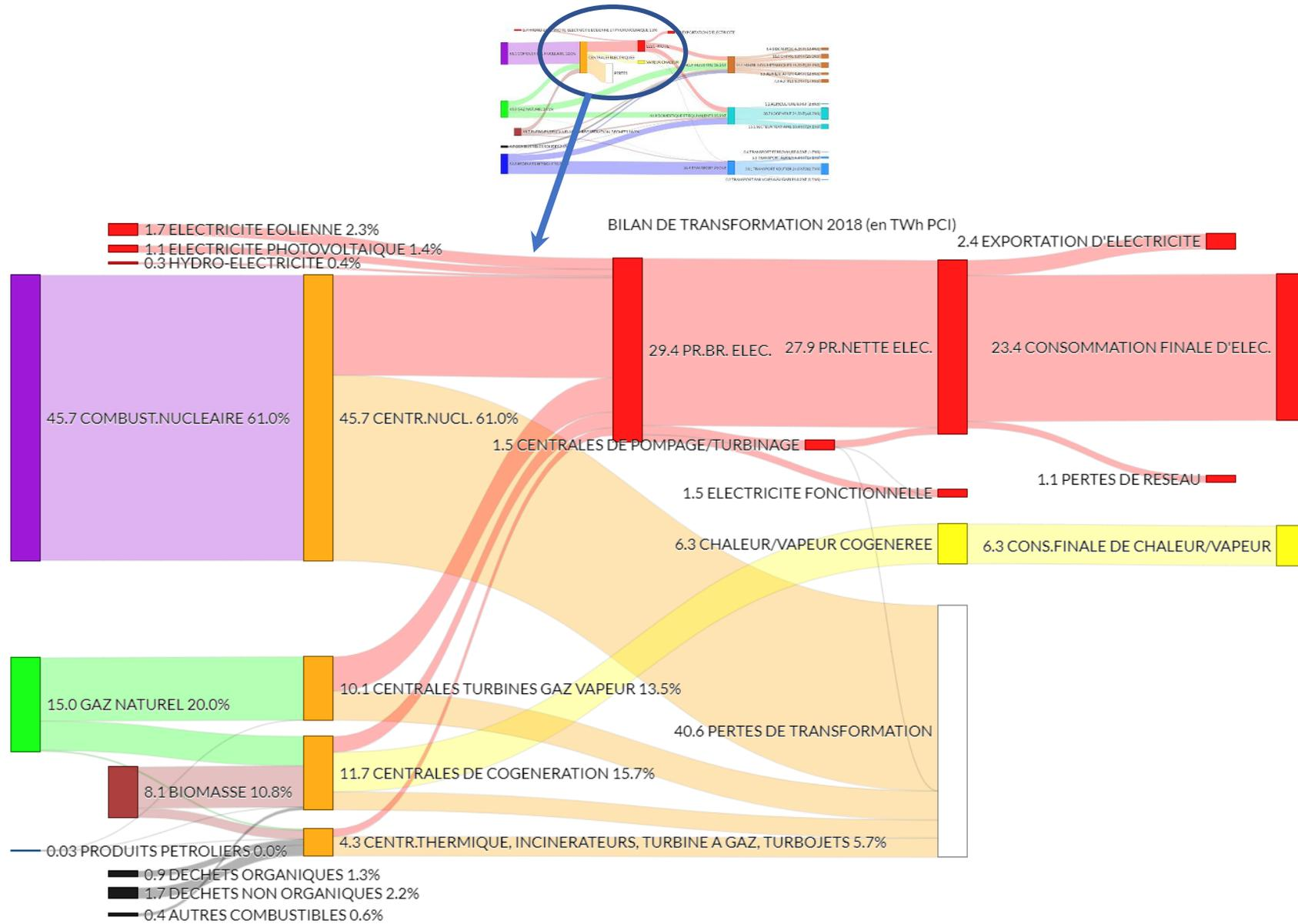
Figure 79 - Diagramme des flux énergétiques du bilan de transformation de la Wallonie en 2018 (en TWh PCI et en %)
