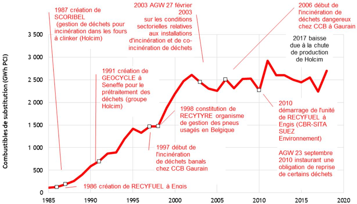
Figure 38 - Historique de la consommation de combustibles de substitution des cimenteries en Wallonie
