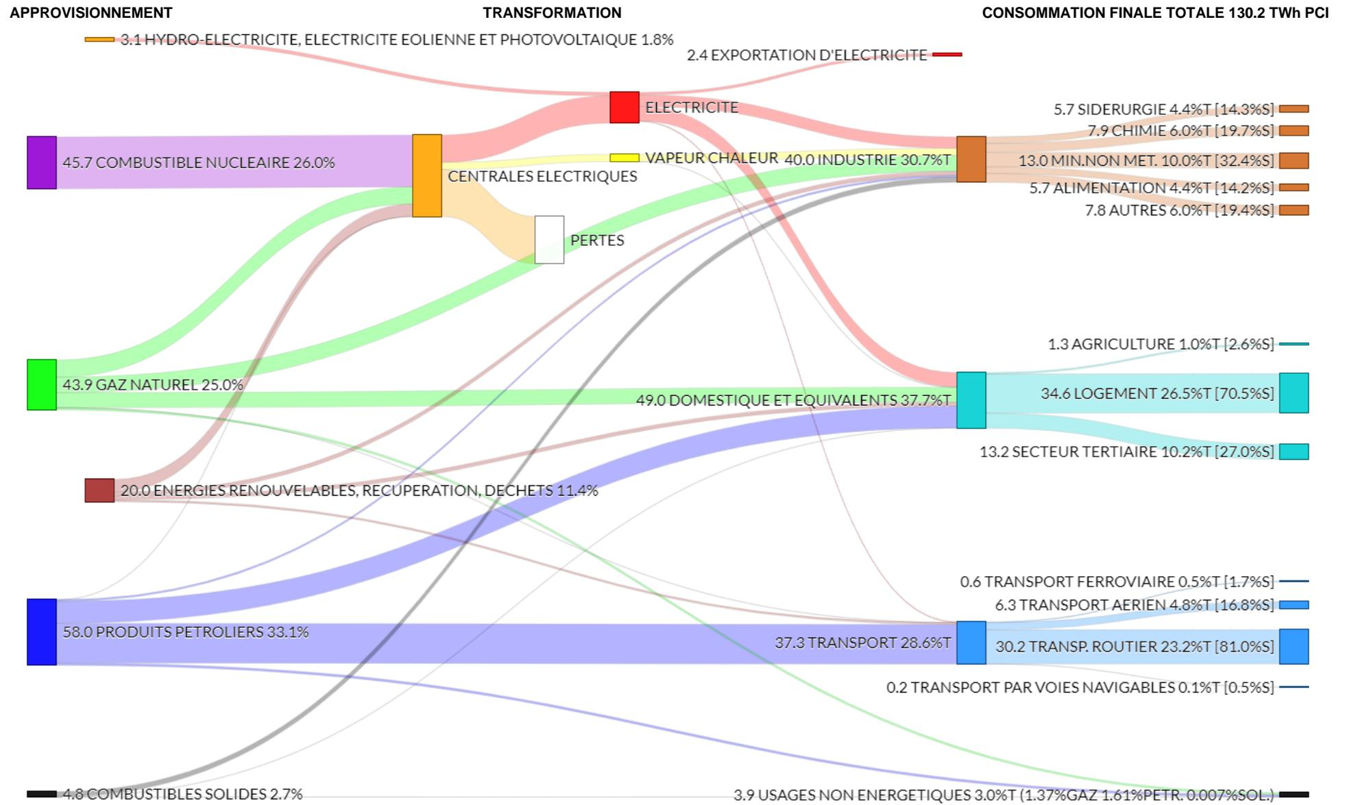
Figure 78 - Diagramme des flux énergétiques de la Wallonie en 2018 (avec les usages non-énergétiques extraits des secteurs qui les consomment)
