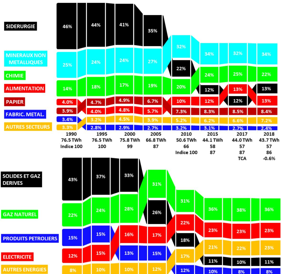
Figure 64 - Evolution de la consommation finale d'énergie de l'industrie par secteur et par vecteur y compris les usages non énergétiques
