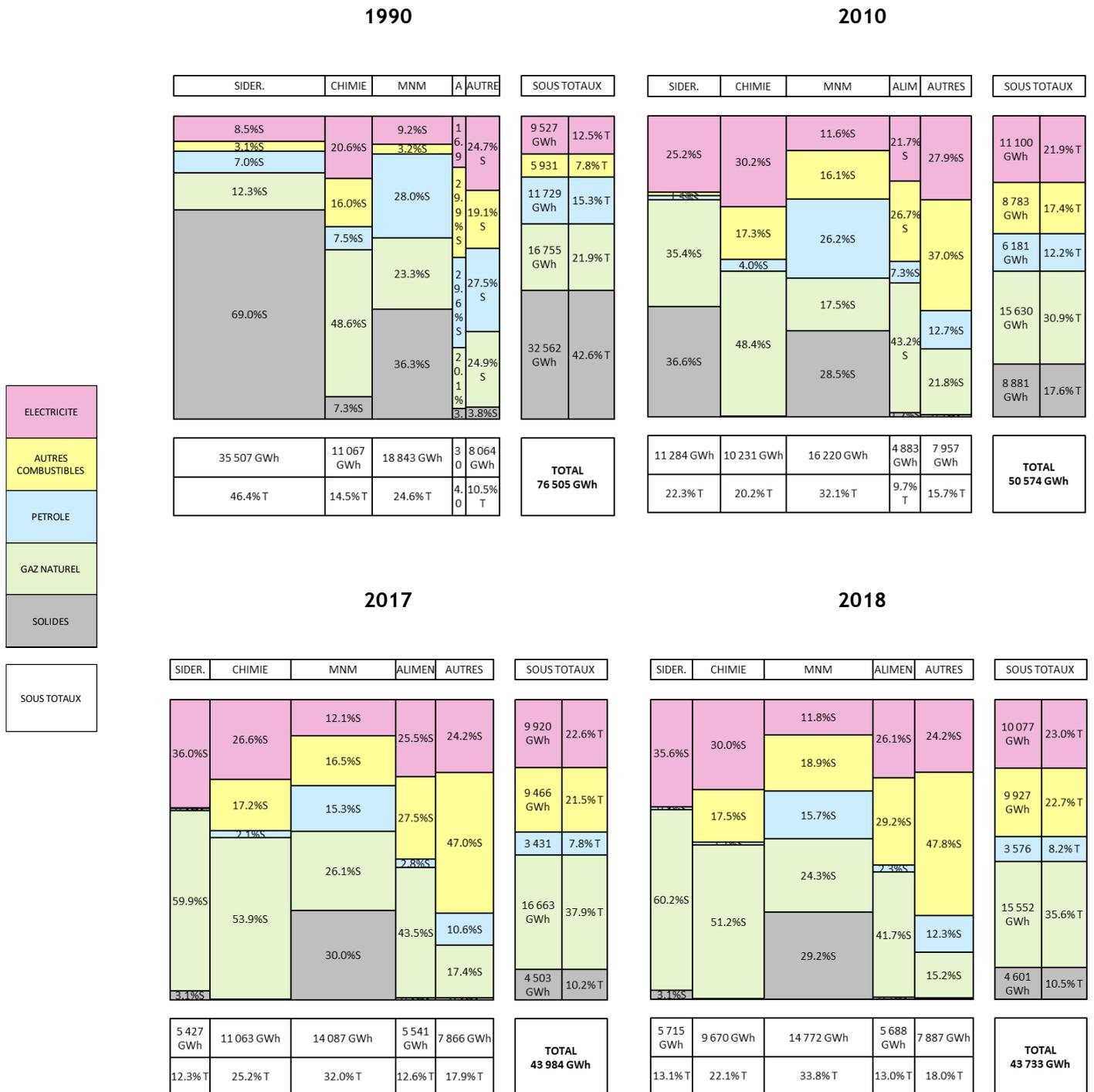
Figure 65 - Evolution de la répartition de la consommation finale d'énergie de l'industrie **y compris les usages non énergétiques** par secteur et par vecteur
