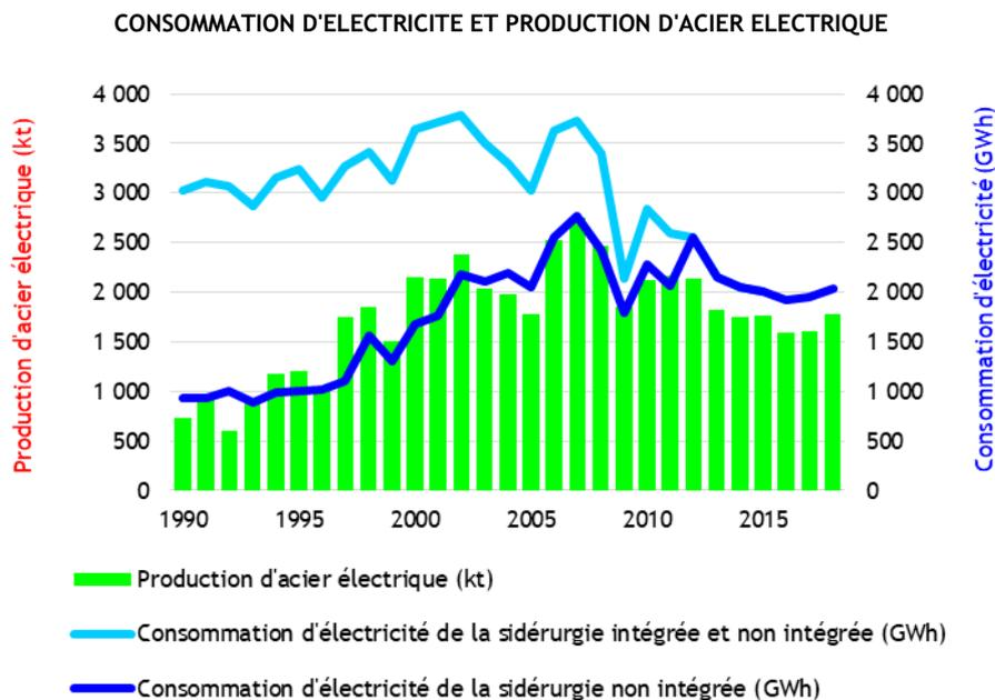
Figure 28 - Evolution de la production et de la consommation d'énergie dans la sidérurgie wallonne
