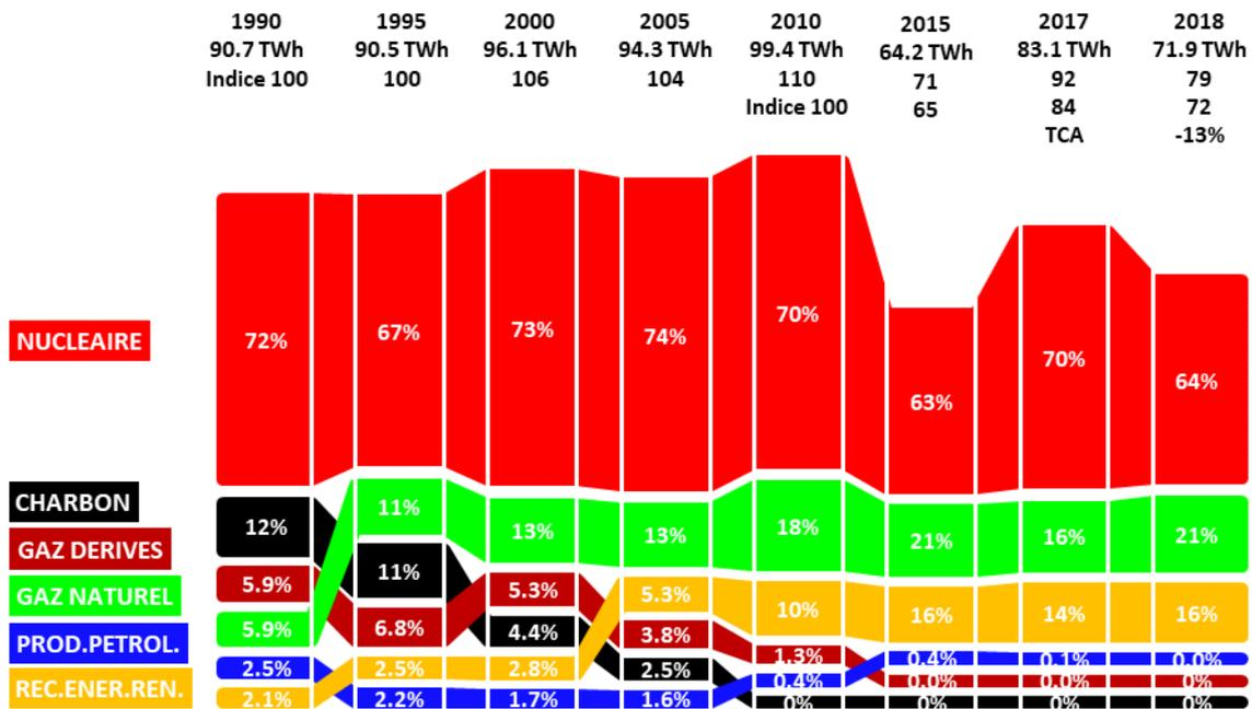
Figure 72 - Répartition des énergies utilisées pour la production d'électricité hors électricité primaire<sup>13</sup> et hors centrales de pompage/turbinage
