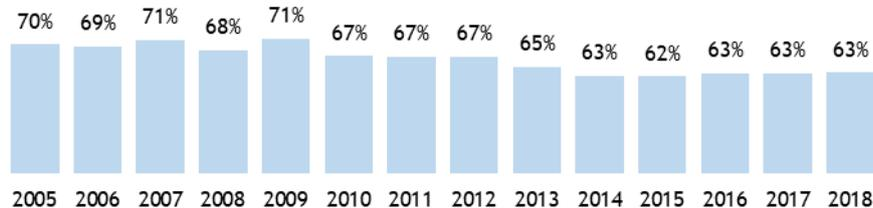
Figure 40 - Taux d'incorporation du clinker dans le ciment produit en Belgique
