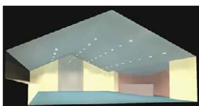
Une étude dite « Dialux » par exemple peut être réalisée pour connaître le type et la quantité de luminaires à placer en fonction de leur courbe photométrique, l'environnement, les besoins et les normes...
