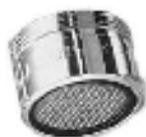
Placer un mousseur sur l'embout du robinet. Il réduit le débit du robinet en réduisant la section de passage de l'eau qui se mélange à de l'air ce qui donne un « effet mousse ».
