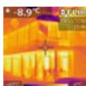
Les pertes thermiques de l'enveloppe peuvent être confirmées par l'utilisation de la caméra thermographique.
