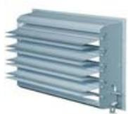
Les ailettes seront orientées de manière intelligente vers les zones à chauffer et pas vers les obstacles éventuels situés dans le local (tentures ou volets de séparation, ...). La vitesse de l'air pulsé sera étudiée pour ne pas gêner les sportifs. Des normes imposant des vitesses d'air maximales sont d'ailleurs à respecter pour la pratique de certains sports.
