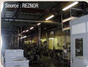
Entreprise Gerken-Europe à Petit-Rechain (produits usinés en carbone et graphite) : remplacement de 8 anciens aérothermes d'une puissance totale de 930 kW par 6 unités à condensation de 107 kW et une de 55 kW. Economie de gaz de 30 % ou environ 7000 EUR/an.
