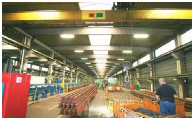
Tubes fluorescents T5 (4 X 80W) et cellule crépusculaire
