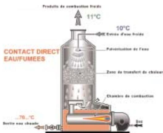
Schéma de principe de la chaudière installée chez Traitex. Un rendement sur PCS de plus de 100 %!
