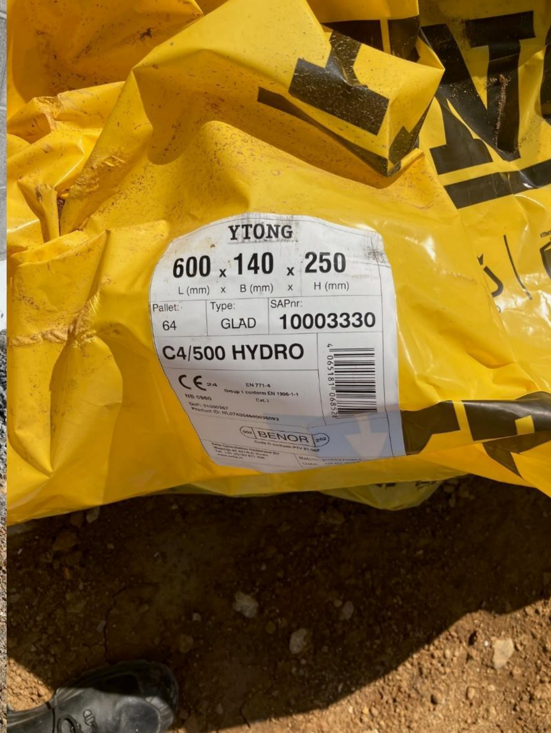
1) Bloc Ytong pour intercalaire isolant au pied de mur en bloc béton
