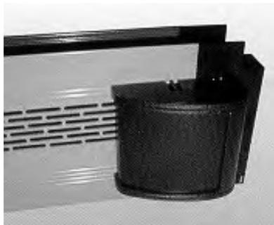
Aérateur à clapet auto-réglable à coupe thermique et commande motorisée s'intégrant entre le châssis et le vitrage
