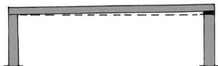
Cette solution évite d'avoir recours à une pente supplémentaire et offre l'avantage de réduire le poids de la forme de pente ainsi que de limiter l'humidité de construction. En pratique, toutefois, il n'est pas toujours possible de réaliser une parfaite évacuation des eaux sans prévoir localement une forme de pente supplémentaire.
