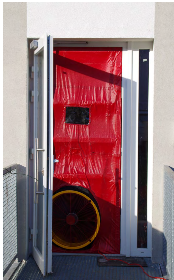
TEST D'ÉTANCHÉITÉ À L'AIR
