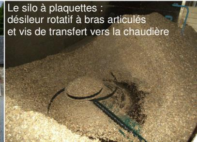
Le silo à plaquettes : désileur rotatif à bras articulés et vis de transfert vers la chaudière
