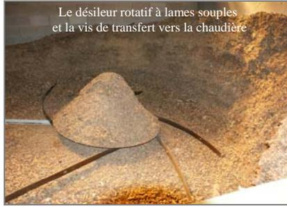
Le désileur rotatif à lames souples et la vis de transfert vers la chaudière
