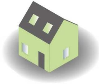
Renoviertes Gebäude (in Grün) mit neuer Fassadenbeschichtung, weißem Putz auf Dämmung, Öffnung von 2 Fenstern im Dach und Dämmung des letzteren ohne Änderung der Abdeckung (in Grün).
