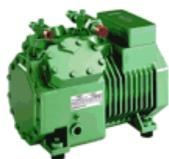
A l'heure actuelle, les compresseurs les plus répandus pour la réfrigération commerciale de petite et moyenne puissance sont les compresseurs à pistons semi-hermétique (le moteur électrique n'est pas démontable mais les pistons sont accessibles). Ces compresseurs ont l'avantage d'être très résistants et de ne pas demander beaucoup d'entretien ou de remplacement de pièces. Ils sont par contre limités au niveau de la puissance frigorifique.
