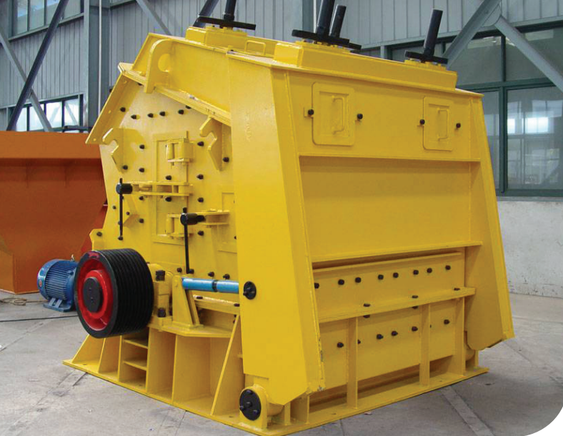
Concasseur à percussion, vue et schéma de principe. Sources : Xhballmill.com, ballmillfactory.com.
