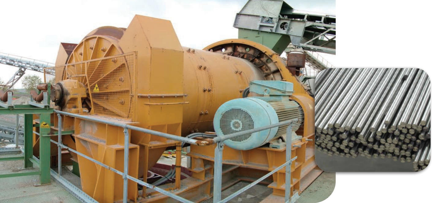
Broyeur à barres et barres de broyage de précision. Sources : memitali.com, alibaba.com.
