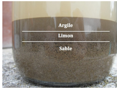
Test de sédimentation permettant d'évaluer la composition de la terre du site (l'échantillon ici présenté ne provient pas d'usite).
