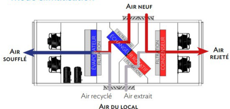
FIGURE 23 : PRINCIPE DE FONCTIONNEMENT D'UNE POMPE À CHALEUR AIR-AIR DOUBLE FLUX ( HTTPS://WWW.THERECO-EUROPE.COM/DOCUMENTATIONS ).
