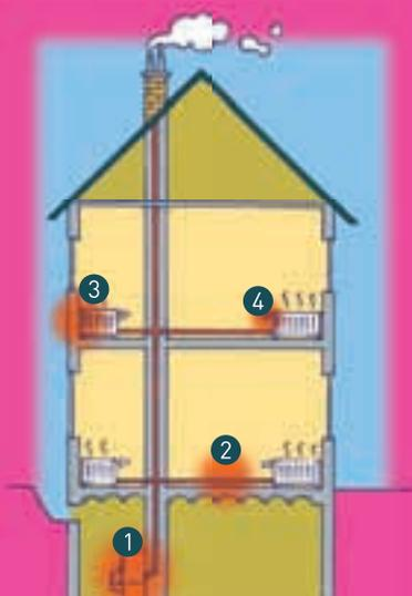
1. L'énergie produite n'est jamais intégralement transmise à l'eau circulant dans les canalisations (*pertes thermiques de la chaudière, par les fumées...*).
