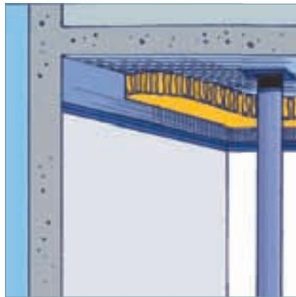
L'étanchéité à l'air est assurée par la pose d'un frein/pare-vapeur entre le sol et l'isolant et sur le haut des murs. Des bandes adhésives spéciales permettent la jonction étanche du frein/pare-vapeur avec les murs. Le passage de la colonne est rendu étanche à l'air grâce à la pose d'un manchon et de bandes adhésives adaptés.
