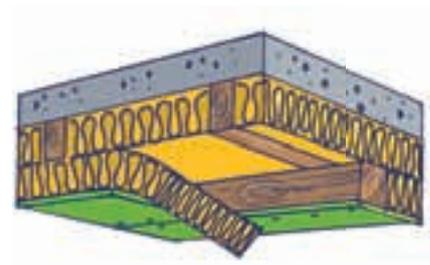
Insufflation de cellulose. Un film technique translucide permet de contrôler le remplissage de l'isolant. Projetée humide, la cellulose colmate toutes les éventuelles irrégularités du support et des éléments en bois.
