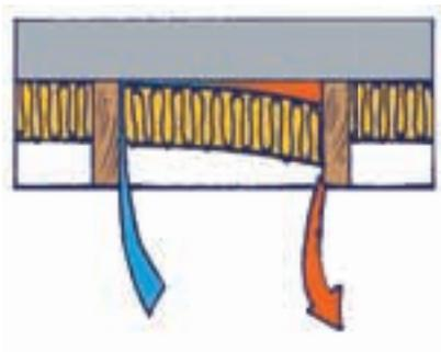
Pour une isolation efficace et éviter les risques de condensation, les panneaux isolants doivent adhérer parfaitement au support.
