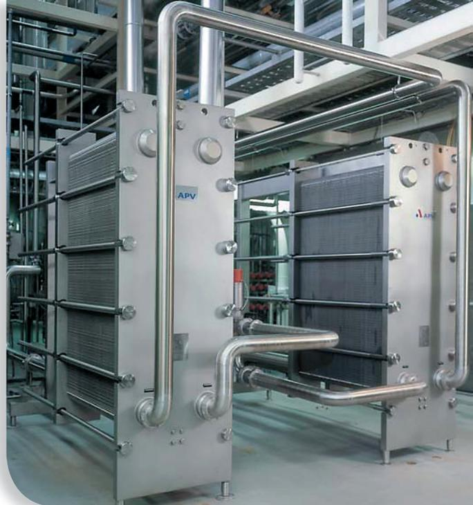
Echangeur pasteurisateur pour du lait. Source : APV
