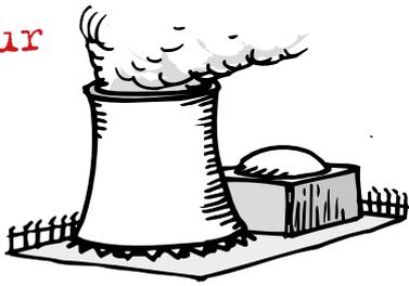
**Les centrales thermiques fossiles** brûlent du gaz, du pétrole ou du charbon pour chauffer l'eau qui se transforme en vapeur qui fait tourner la turbine.
