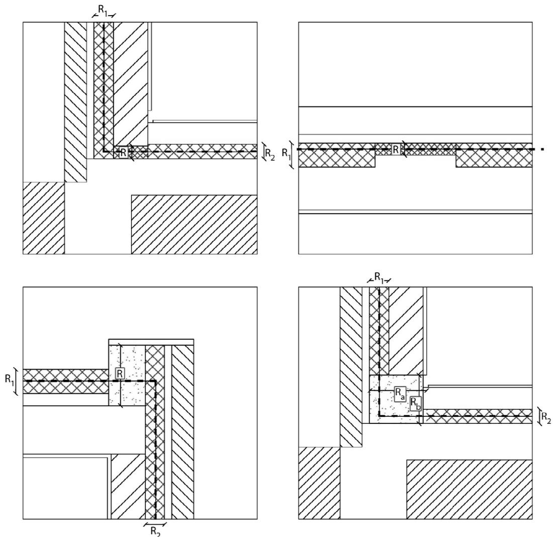
**Figure 4 - Direction du mesurage de la résistance thermique R des éléments isolants**
