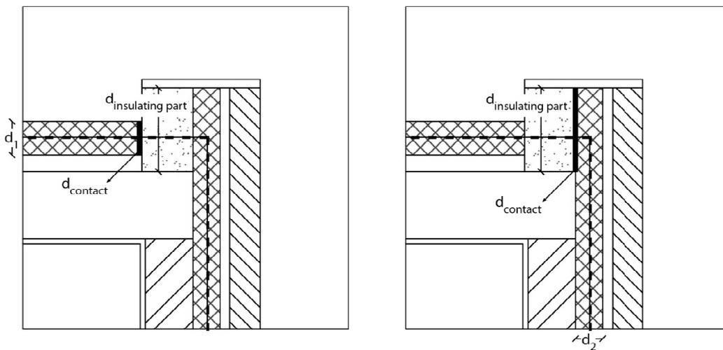
Figure 5 - Exigence d'épaisseur de contact  $d_{\text{contact}}$  à satisfaire par chaque raccord.
