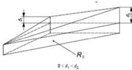
**Figure 9 – Éléments de construction avec base triangulaire, composés d'une partie inclinée (avec épaisseurs différentes à chaque pointe) et d'une partie plane (restante)**
