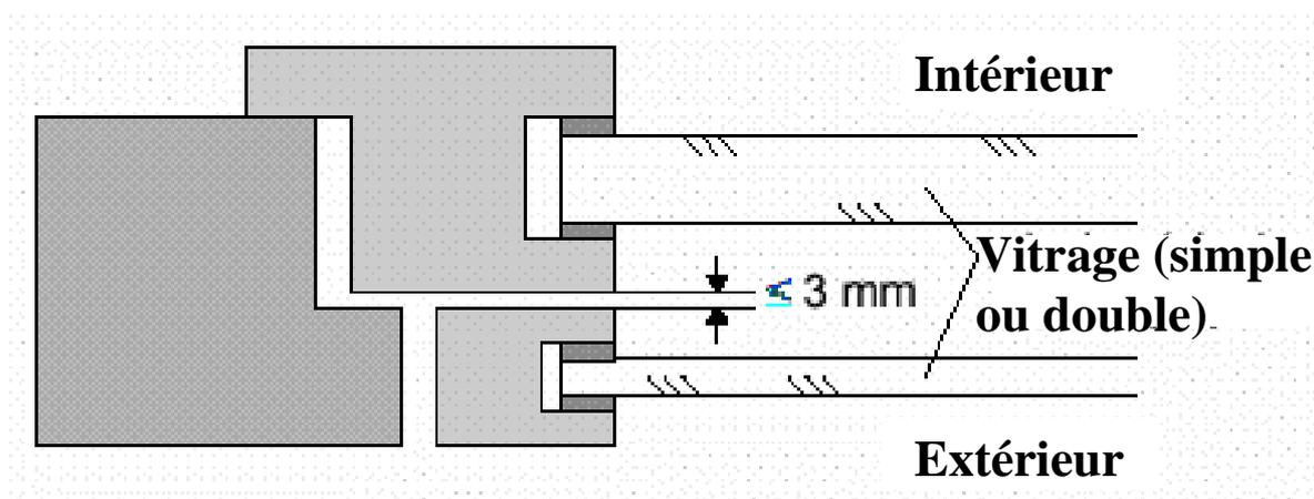
Figure 17 – Illustration d'une fenêtre à vantaux dédoublés
