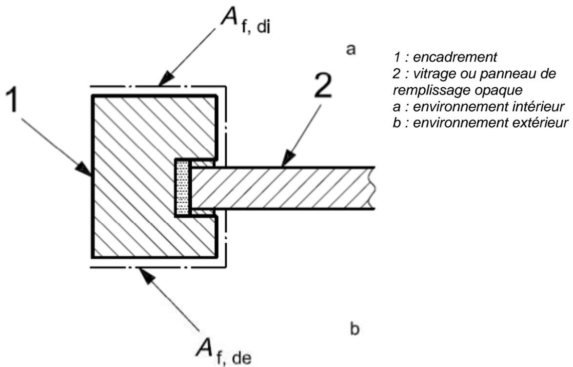
Figure 13 – Aires développées des encadrements
