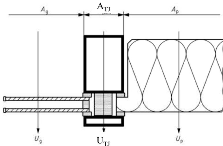
**Figure 26 – Liaison considérée comme un élément de façade ayant une aire propre**
