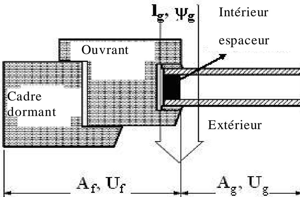
Figure 15 – Effet du vitrage, intercalaire et encadrement
