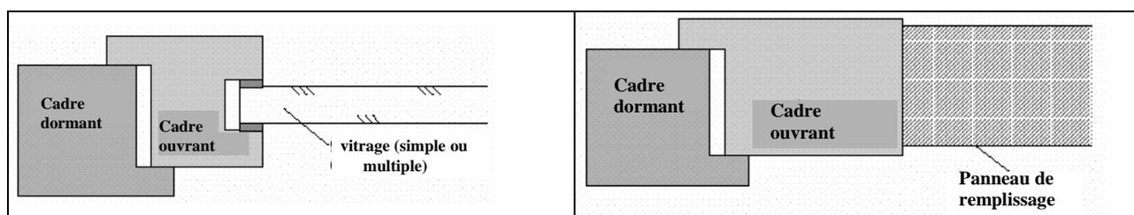
Figure 14 – Illustration d'une fenêtre ou porte simple
