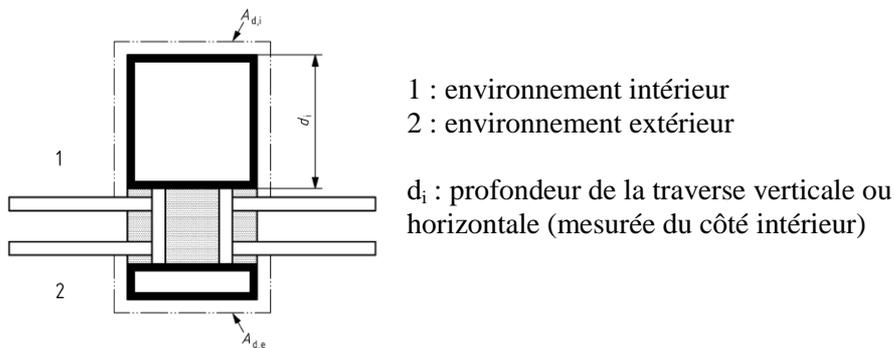
**Figure E.2 – Profondeur intérieure des traverses**
