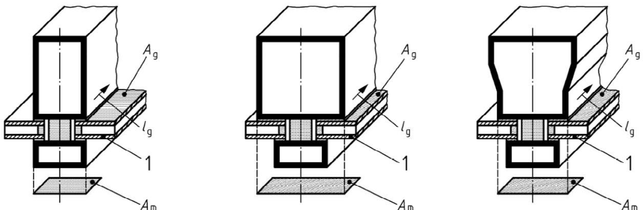
Figure 24 – Schéma de l'aire vitrée et du périmètre (1 : verre)
