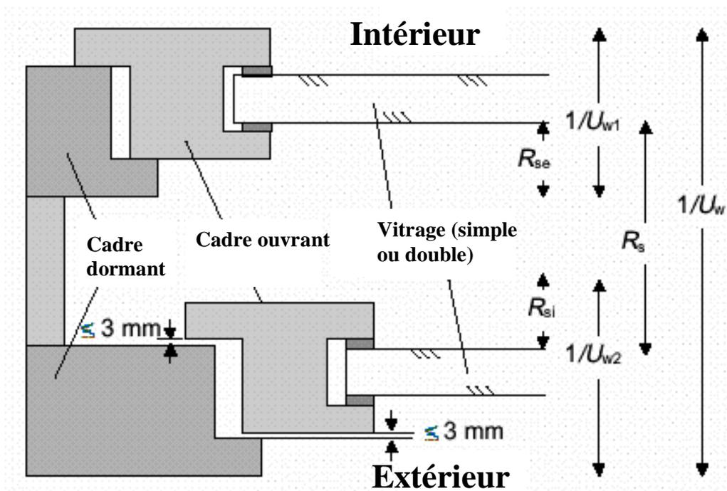
Figure 16 – Illustration d'une double fenêtre
