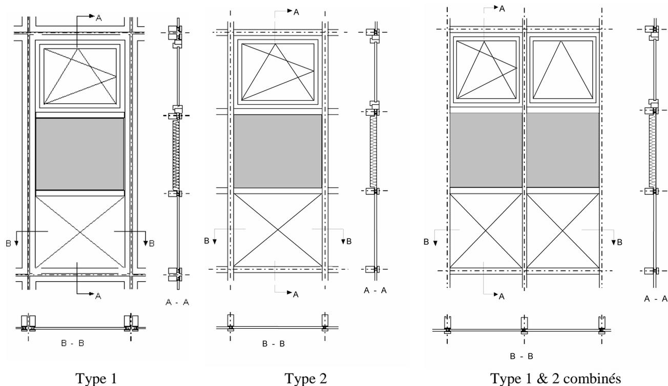
Figure 22 – Délimitation des aires des modules d'une façade légère
