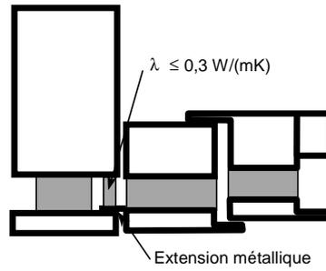
Montage du profilé sur la traverse par usage d'une extension du profilé aluminium extérieur.
