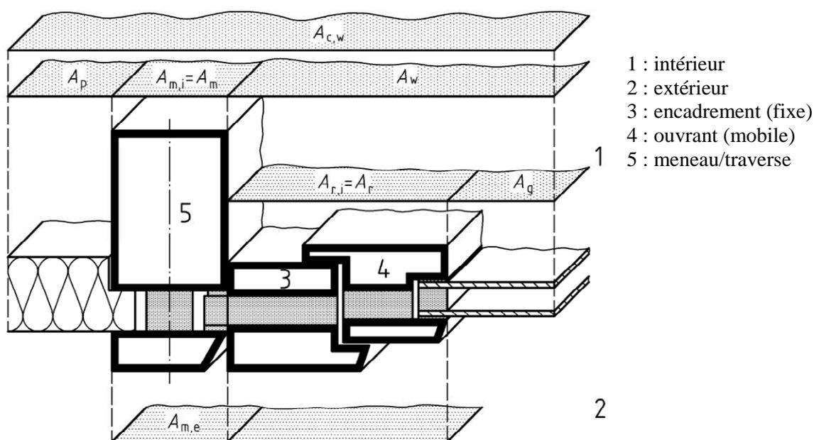
Figure 29 – Divisions du module en sous-composants ayant des aires propres et des valeurs  $U$  propres
