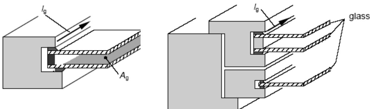
Figure 10 – Illustration de l'aire du vitrage et du périmètre
