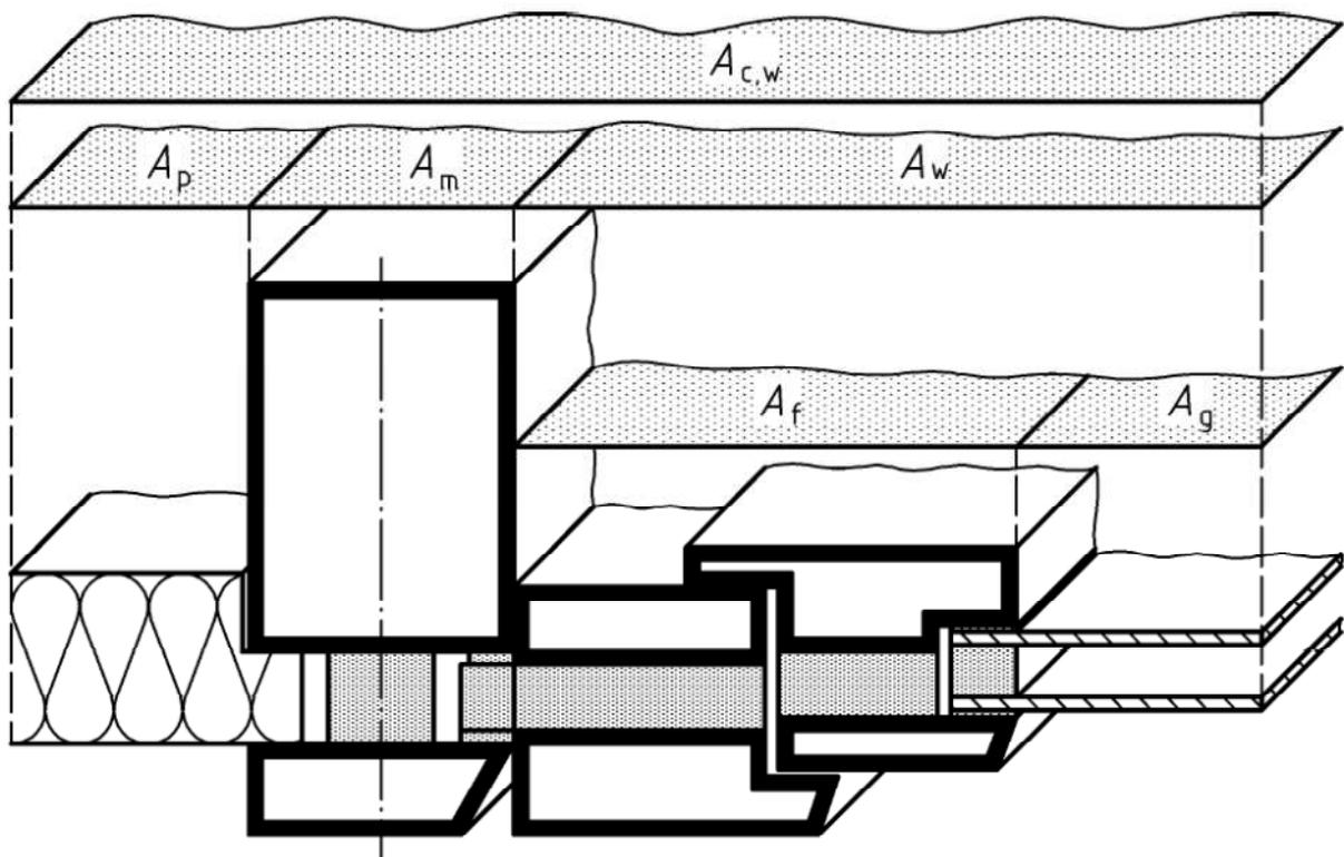
Figure 23 – Illustration des aires projetées d'une façade légère
