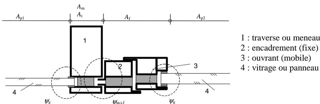
Figure 30 – Jonction d'un module de façade légère à un meneau ou une traverse
