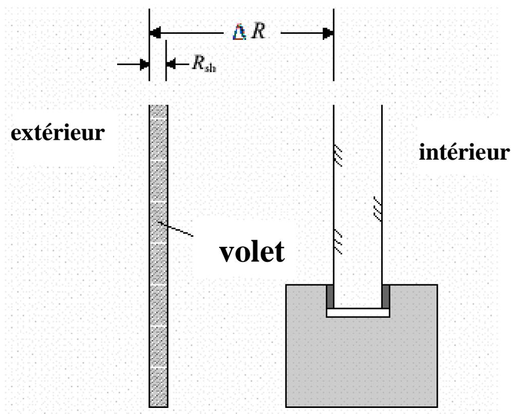
Figure 18 – Fenêtre avec volet fermé
