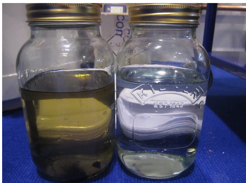
Fig. 31. L'antigel transparent qui «vieillit» au fil des ans
