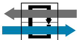
Échangeur à récupération indirecte par fluide intermédiaire
