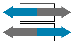
Échangeur récupérateur en alternance
