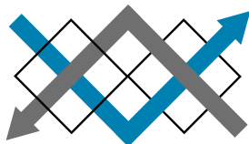
Échangeurs à plaques à courant croisés
