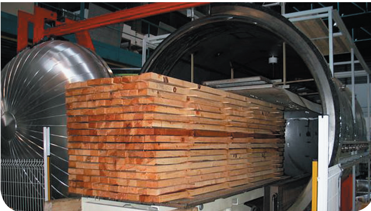
Séchage par utilisation simultanée d'un champ électromagnétique haute fréquence et d'une atmosphère saturée en humidité. Source(s) : Woodsurfer, Drywood
