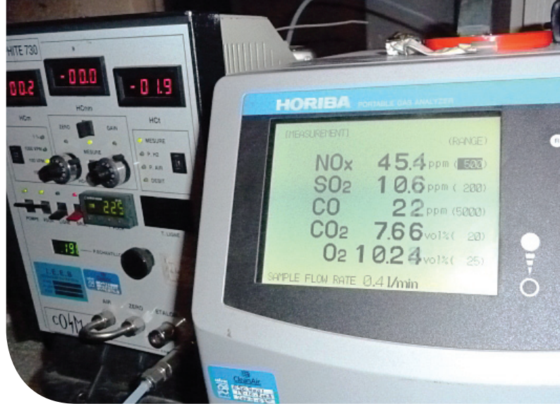
Contrôle de la qualité de combustion. Source : ecologie.
